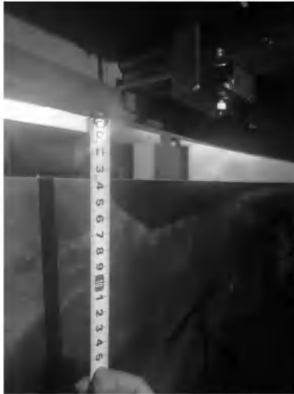
图 3 镀槽与操作臂之间的空隙只有 36mm
