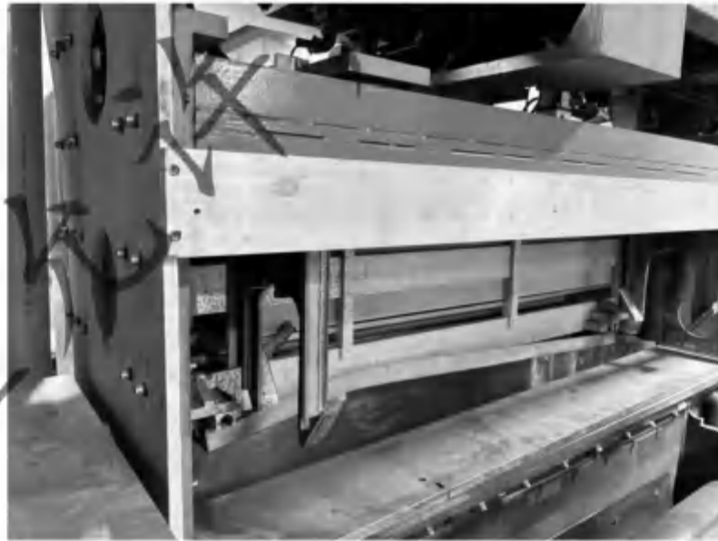
图 4 夹住死者的机械手（电镀件吊具，已弯曲变形）
