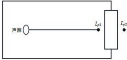
图 4-1 室内声源等效为室外声源图例
