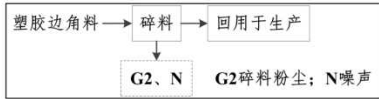
图 2-6 原项目碎料工艺流程及产污环节图
