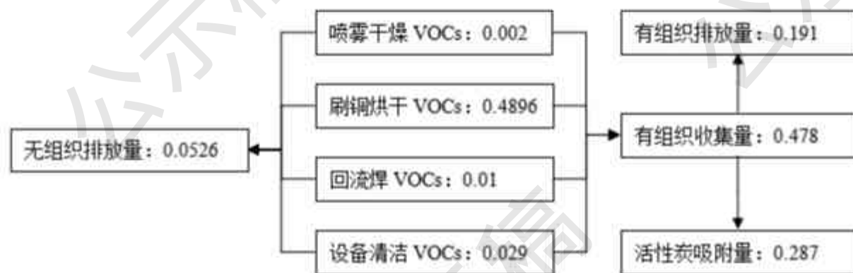
图 2-3 项目 VOCs 平衡图
